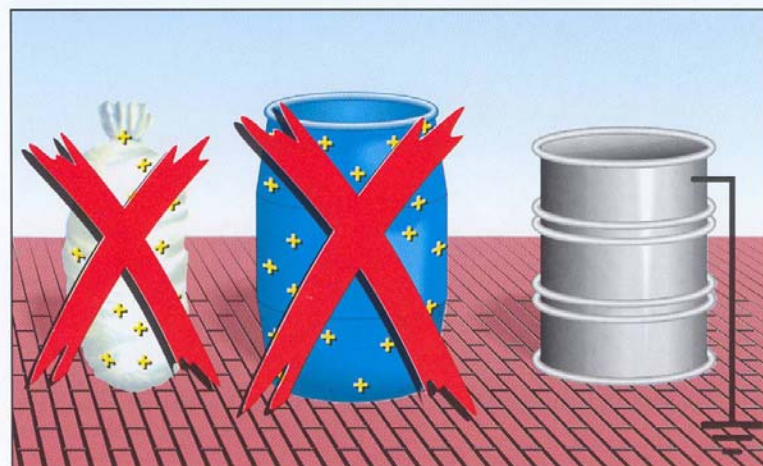
Abb. 2: Vermeiden von elektrostatischer Aufladung: Verwenden von leitfähigen, geerdeten Packmitteln (keine Kunststoffsäcke oder Kunststoffbehälter) [1]
